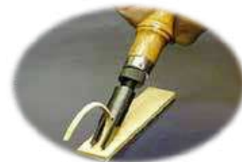
Elaboración de la ranura en las varillas utilizando una gubia
