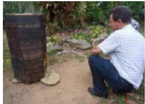
Utilizando un flameador en las cajas de madera
