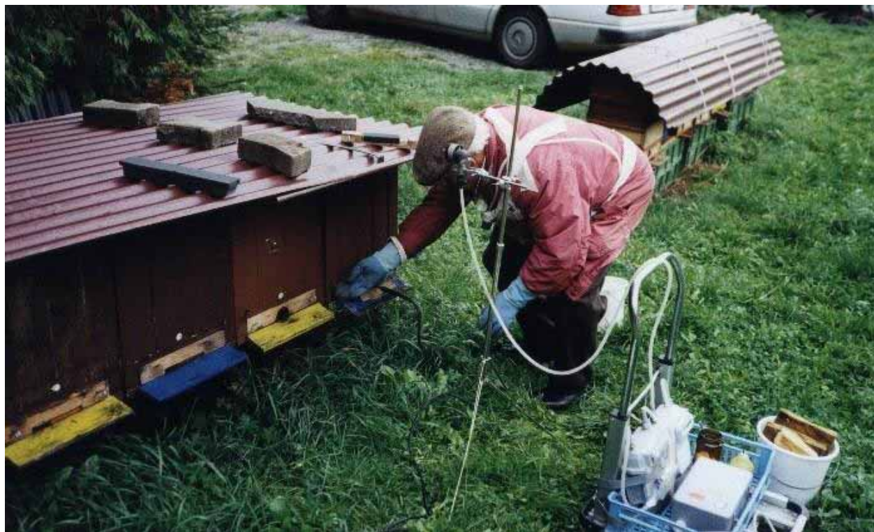
Fig. 6: L'apiculteur introduit l'évaporateur Varroax® dans le trou de vol. Devant celui-ci, on aperçoit la tête de l'appareil de prélèvement des échantillons sur son support. À droite, pompe de prélèvement de l'air et appareil de mesure volumétrique.
