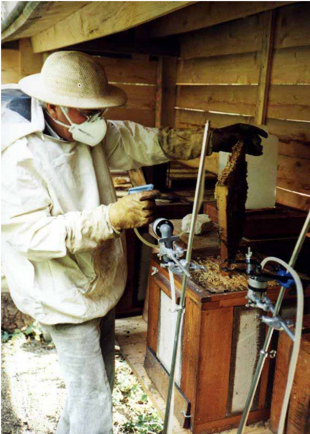
Fig. 4: Les têtes de prélèvement des échantillons sont placées, au moyen de supports, à côté du lieu de travail de l'apiculteur en train de pulvériser (sprayer) un cadre avec une solution d'acide oxalique.
